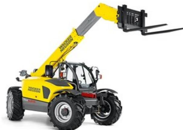
Телескопический погрузчик Wacker Neuson TN 625. Универсальный и мощный подъем 2,5 тн груза на высоту 5,73 метра.
